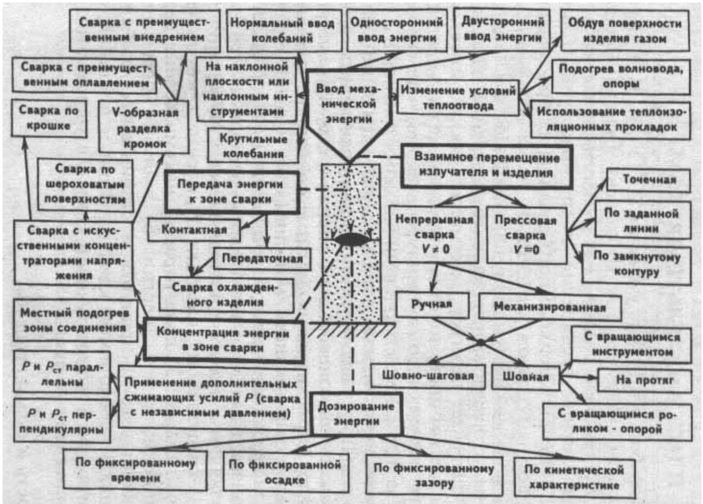
Рис.5.1. Классификация схем ультразвуковой сварки пластмасс
