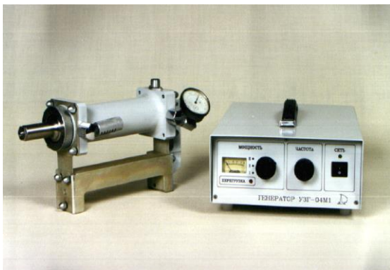
Рис.2. Технологическая система для ультразвуковой финишной обработки тел вращения «УФО – 98»
